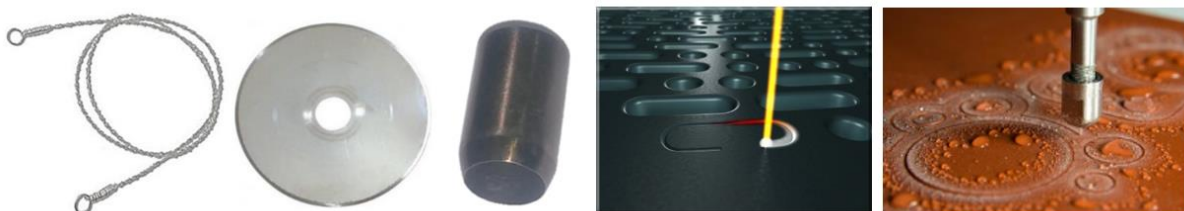
Figura 7: Exemplos de ferramentas para corte. Da esquerda para a direita: fio cortante (extraído de [16]), lamina circular (extraído de [16]), lamina vazadora (extraído de [16]), laser (extraído de [25]) e jato d'água (extraído de [26])
