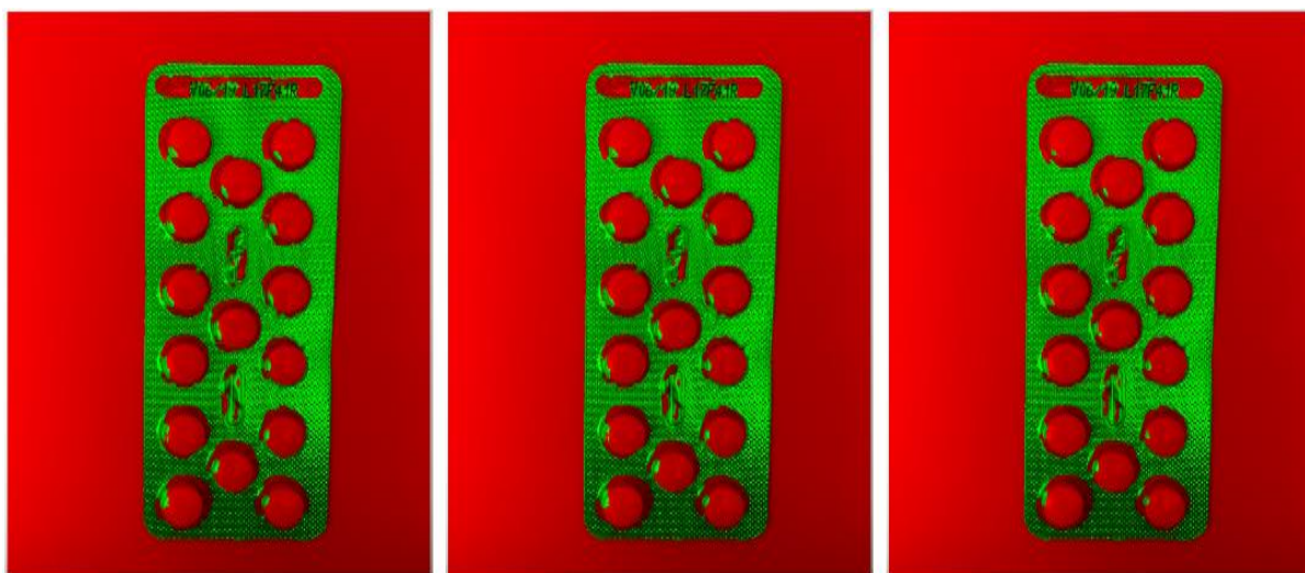
Figura 23: Resultados da Clusterização com dois clusters realizado pelo K-Means com os dados dos histogramas para o primeiro blister da Figura 17. Da esquerda para direita: 1. Uso dos histogramas de ângulo e módulo do gradiente de Sobel. 2. Uso somente do histograma do módulo do gradiente. 3. Uso do histograma do módulo do gradiente e do laplaciano.
