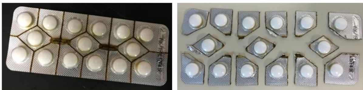
Figura 36: Resultado da unitarização em blister do tipo 1 com 8W e 20mm/s.
