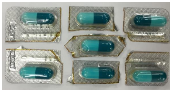
Figura 35: Resultado da unitarização em blister do tipo 3 bem sucedida com 8W e 50mm/s. O laser cortou o plástico e pudemos, com facilidade, cortar o alumínio com as mãos.
