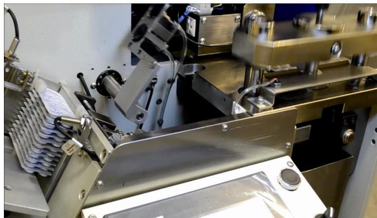
Figura 3: BC100 em processo de corte do blister com matriz e punção (extraída de [13]).
